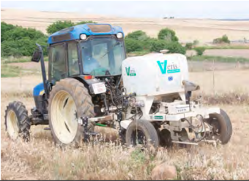
Figura 7: el equipo para medición de conductividad eléctrica del suelo de la Finca La Orden (CICYTEX) trabajando en un yacimiento arqueológico.
