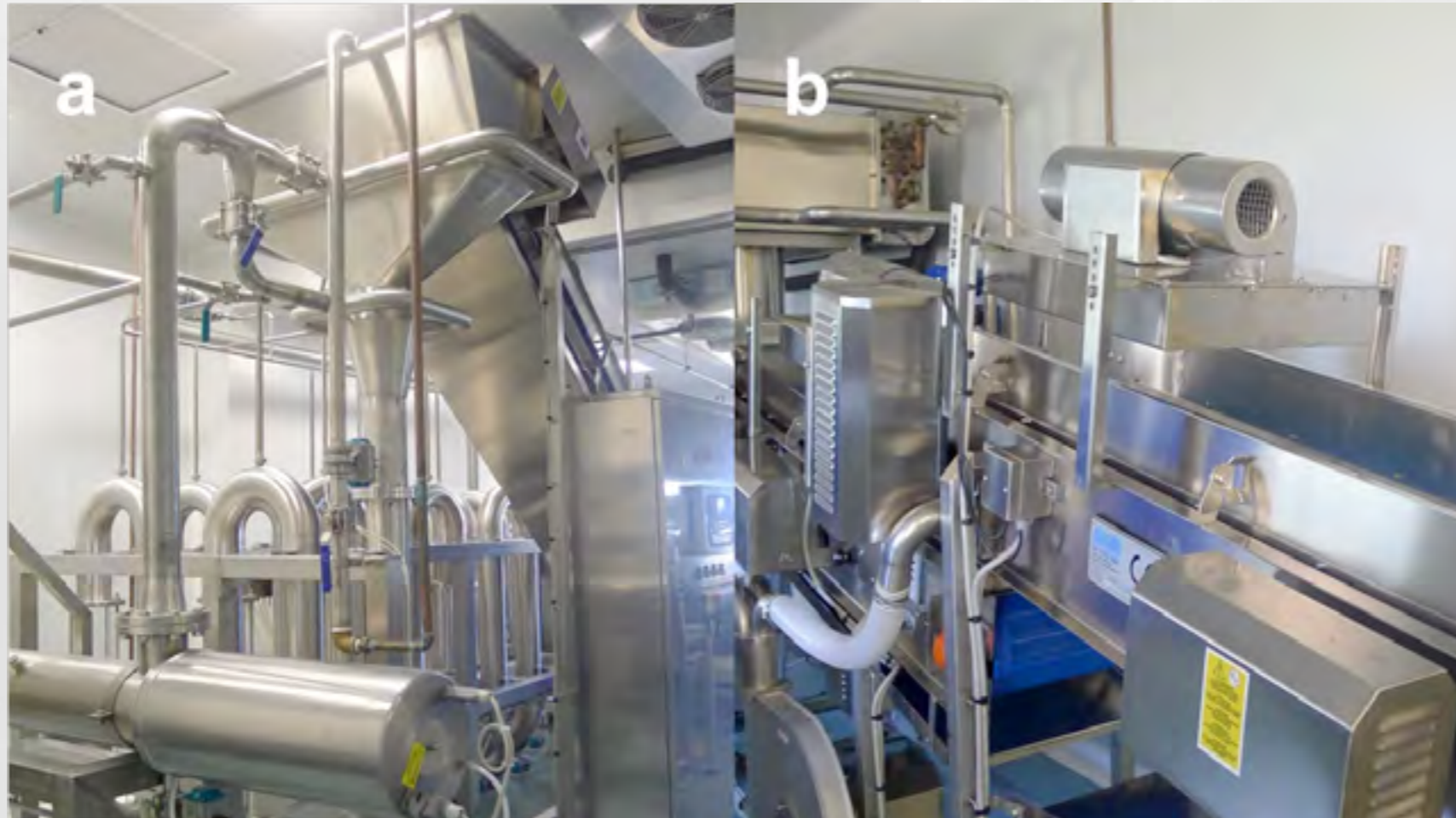
Figura 1: Instalaciones de la sala blanca destinadas al procesado de fruta IV Gama: A) Equipo de lavado; B) Equipo de secado).
