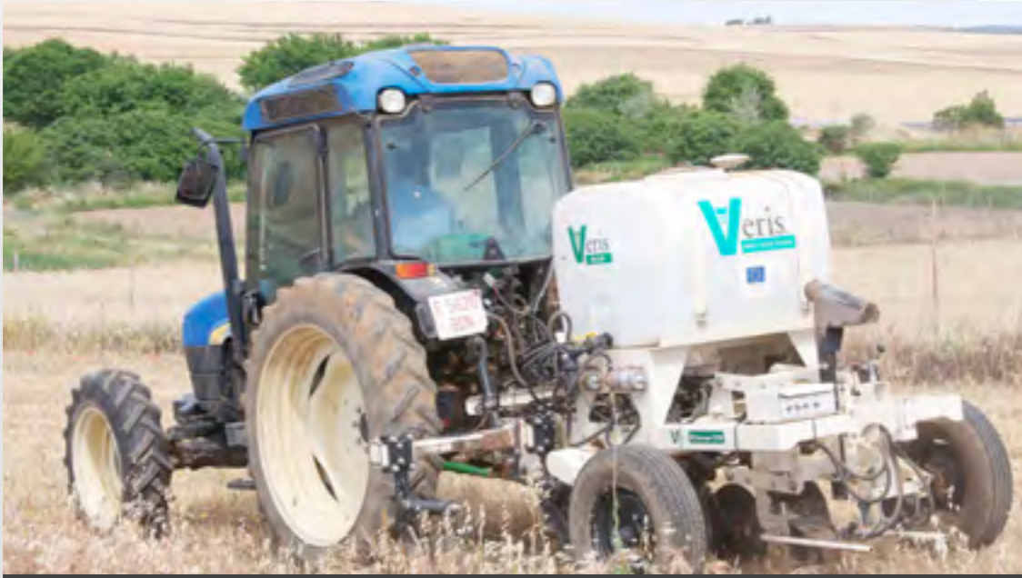
Figura 7: el equipo para medición de conductividad eléctrica del suelo de la Finca La Orden (CICYTEX) trabajando en un yacimiento arqueológico.
